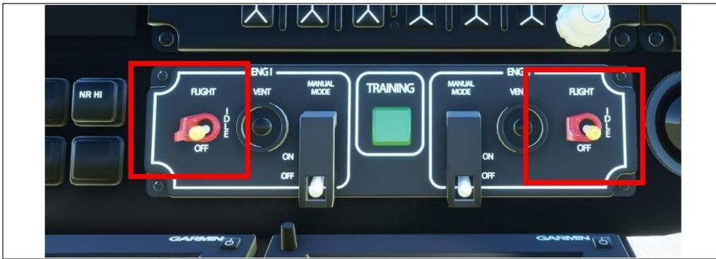
**(Warm start dalla pista)** → Portare un motore da IDLE a FLIGHT per volare, o premi **Ctrl+E**
